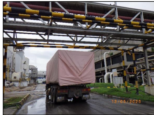
รูปที่ 2-19 การปิดคลุมกระบะรถบรรทุก
