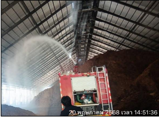
รูปที่ 2-23 การฉีดพรมน้ำบริเวณลานกองเชื้อเพลิง
